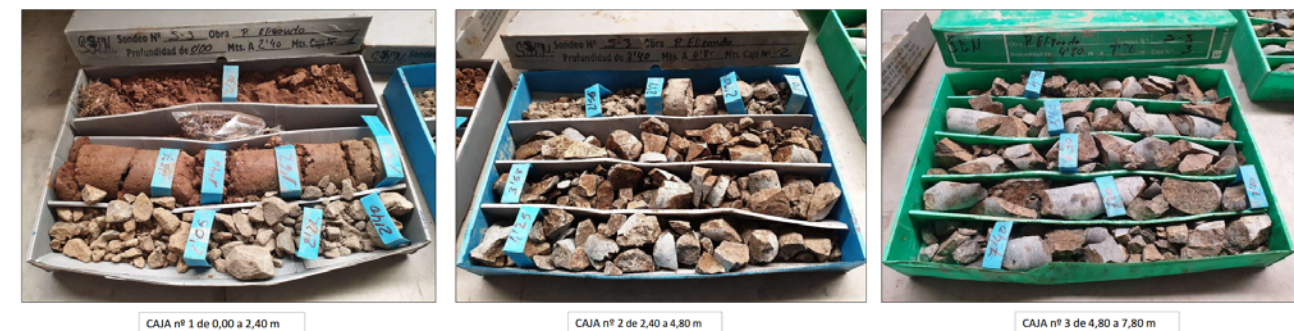
Imagen 9. Sondeo S-3. Ofitas intensamente fracturadas de 1,8 a 7,8 m (Fuente: Elaboración propia)
