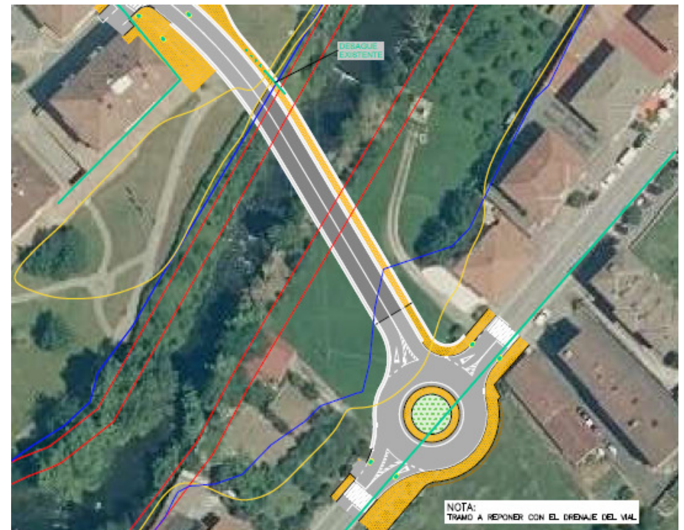
Imagen 19. Reposición de la red de pluviales
