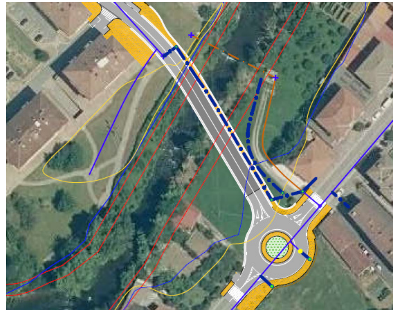
Imagen 17. Reposición de la red de abastecimiento
