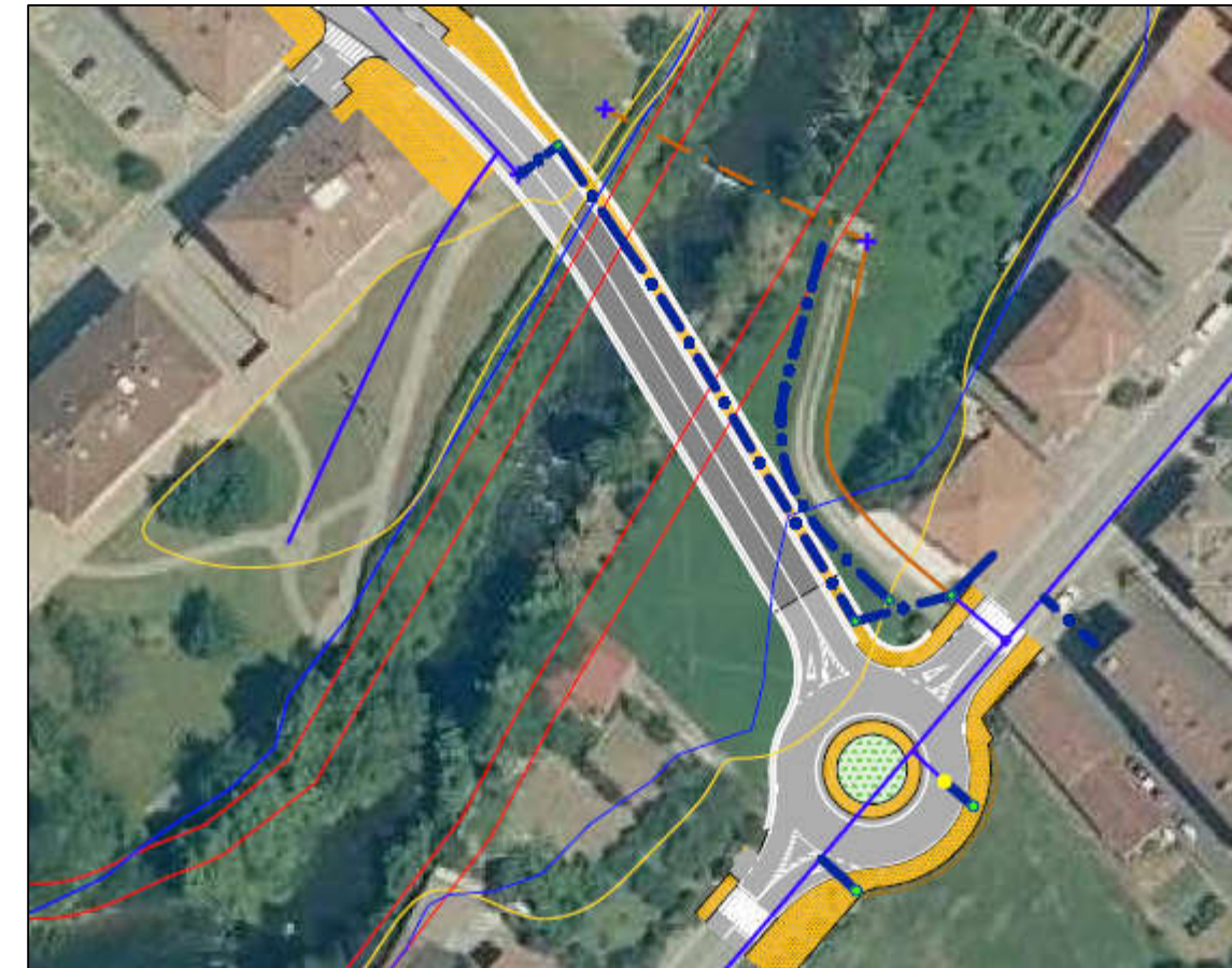
Imagen 37. Reposición de la red de abastecimiento
