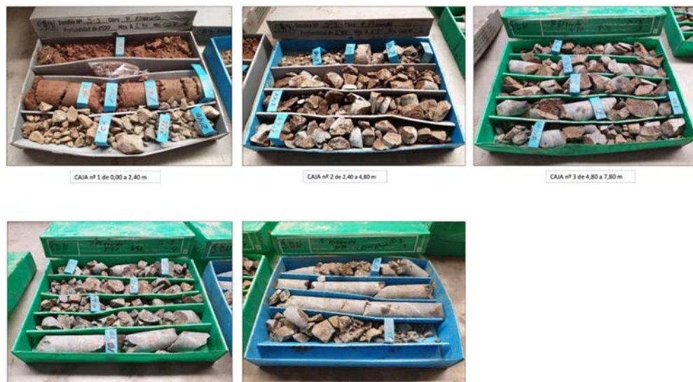
Imagen 15. Sustrato ofítico intensamente fracturado en la zona del estribo 2 (Fuente: Elaboración propia)
