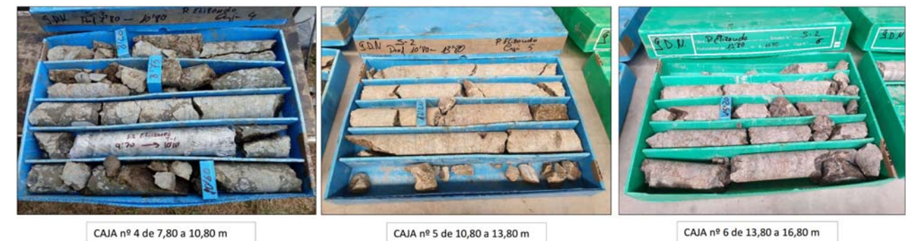
Imagen 8. Sondeo S-2. Ofitas moderadamente fracturadas de 13,0 a 17,8 m (Fuente: Elaboración propia)
