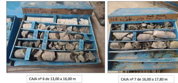
Imagen 7. Sondeo S-1. Ofitas intensamente fracturadas de 13,0 a 17,8 m (Fuente: Elaboración propia)
