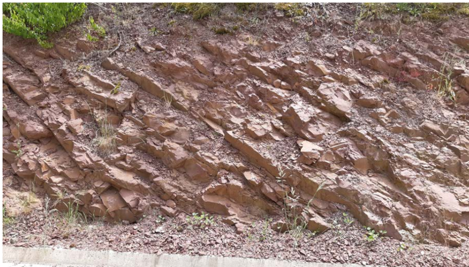
Fotografía 5.2.5.a.- Aspecto de las limolitas rojas en afloramiento de la boca sur del Túnel de Belate.
