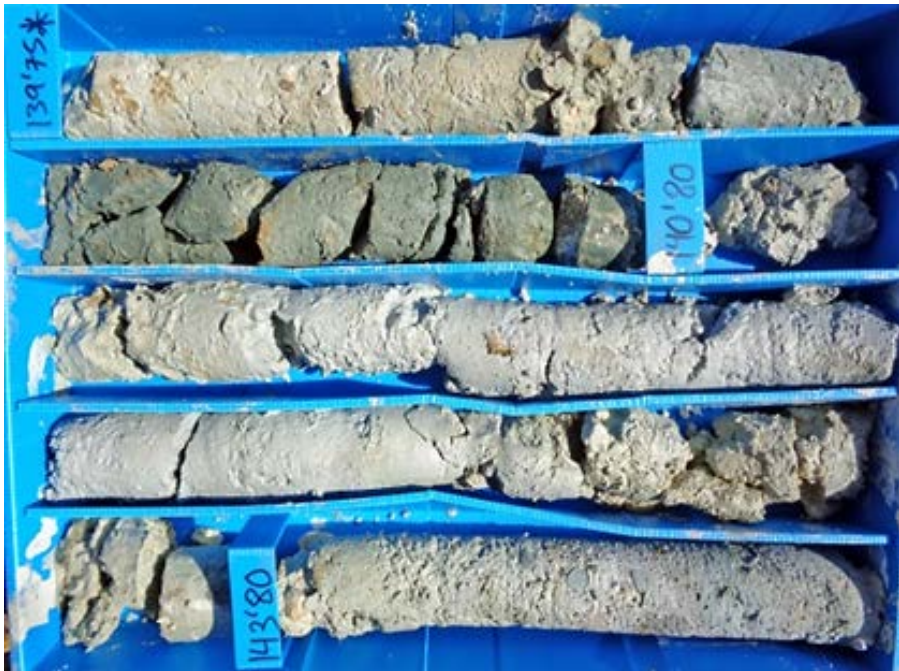
Fotografía 5.2.9.d.- Aspecto de ofitas brechificadas y caolinizadas, presentes a cota de Túnel de Almandoz en el PK 33+600.
