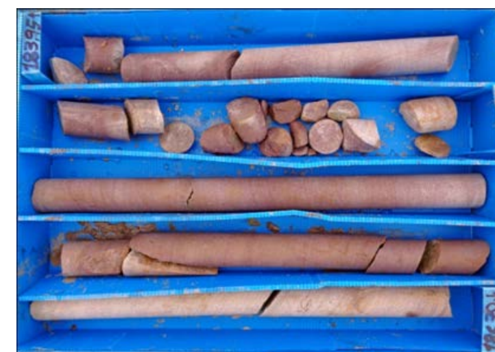
Fotografía 5.2.4.b.- Aspecto de los testigos de areniscas del Buntsandstein a cota del Túnel de Belate II.
