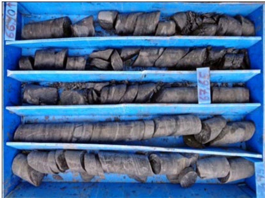
Fotografía 5.2.1.b.- Aspecto de testigos pizarras negras extraídos a cota de túnel en el sondeo S-10.
