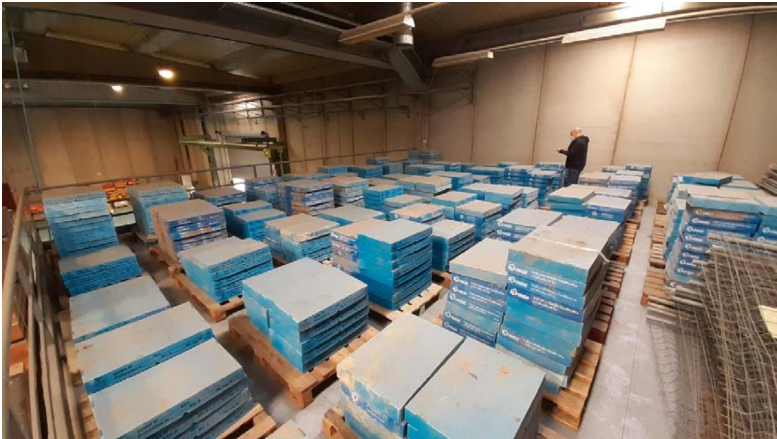
Fotografía 4.2.a.- Almacenamiento de las cajas de los sondeos realizados para el Estudio de Alternativas y el Estudio geotécnico.
