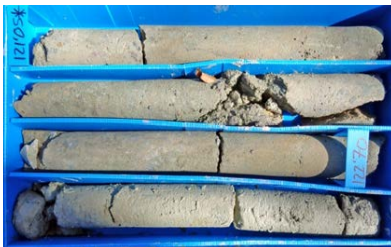
Fotografía 5.2.10.a.- Aspecto de los testigos de brecha poligénica cementada.
