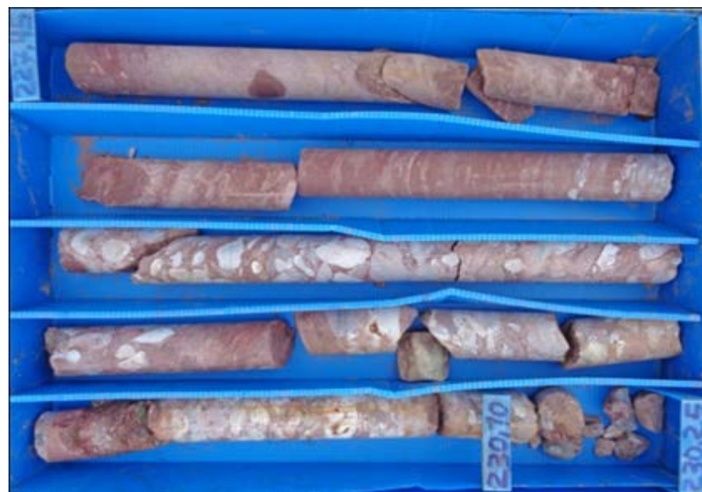
Fotografía 5.2.3.b.- Aspecto de los conglomerados en testigos extraídos a cota del Túnel de Belate II.
