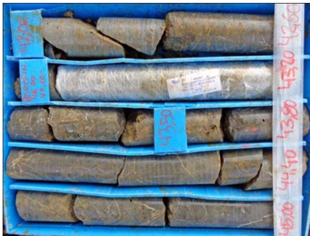
Fotografía 5.2.7.b.- Aspecto de los testigos de caliza de Muschelkalk a cota del trazado.
