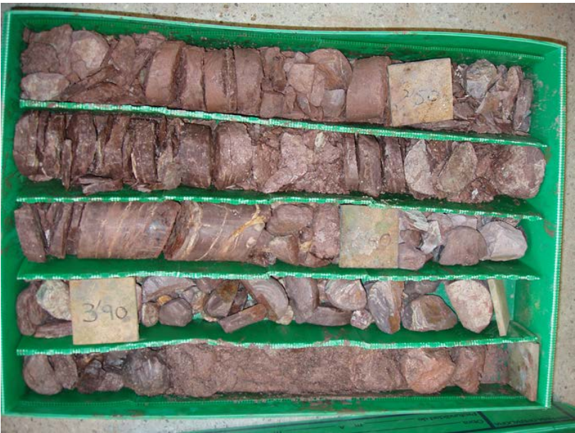
Fotografía 5.2.3.a.- Aspecto de las pelitas rojas extraídas de uno de los sondeos realizado en 2007, por GEOCONTROL, desde el interior del actual Túnel de Belate.
