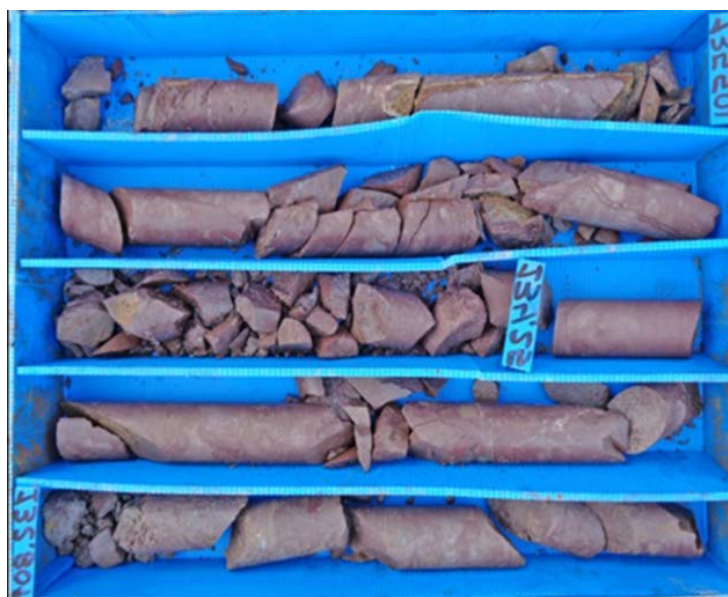
Fotografía 5.2.5.b.- Aspecto de los testigos de limolitas roja a cota de túnel.
