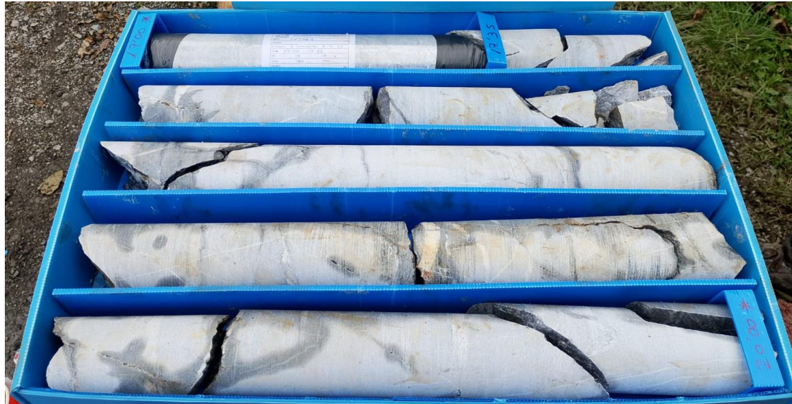
Fotografía 11. Caliza sana con alguna fracturas. Sonde S-4 de 17,00 a 20,00 m.
