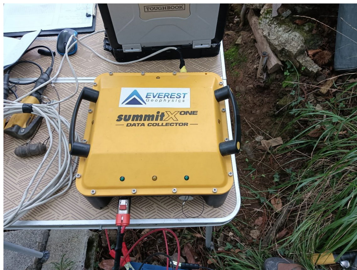
Figura 7. Sismógrafo empleado en la adquisición de datos sísmicos de campo.
