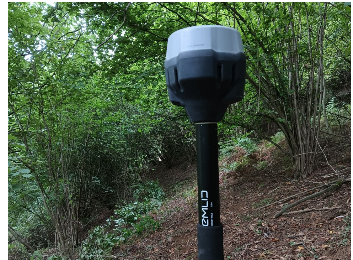
Figura 8. Antena receptora de GPS empleada para geolocalizar los ensayos.
