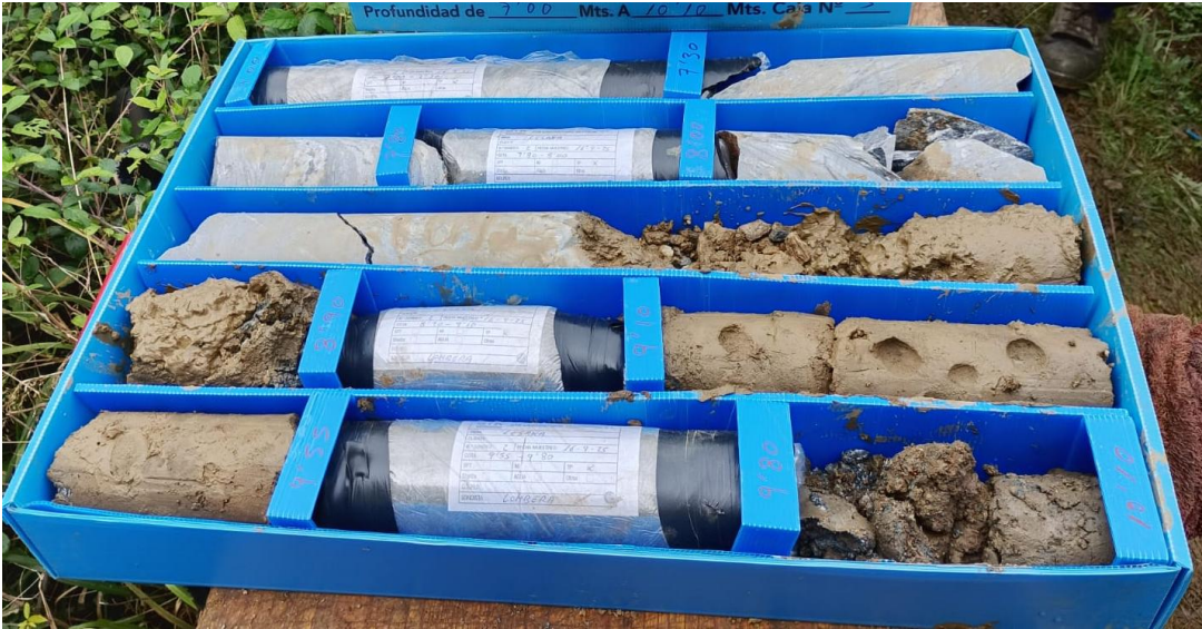
Fotografía 10. Caliza alterada con fracturas llenas de material blando. Sondeo S-2 de 7,00 a 10,10 m.
