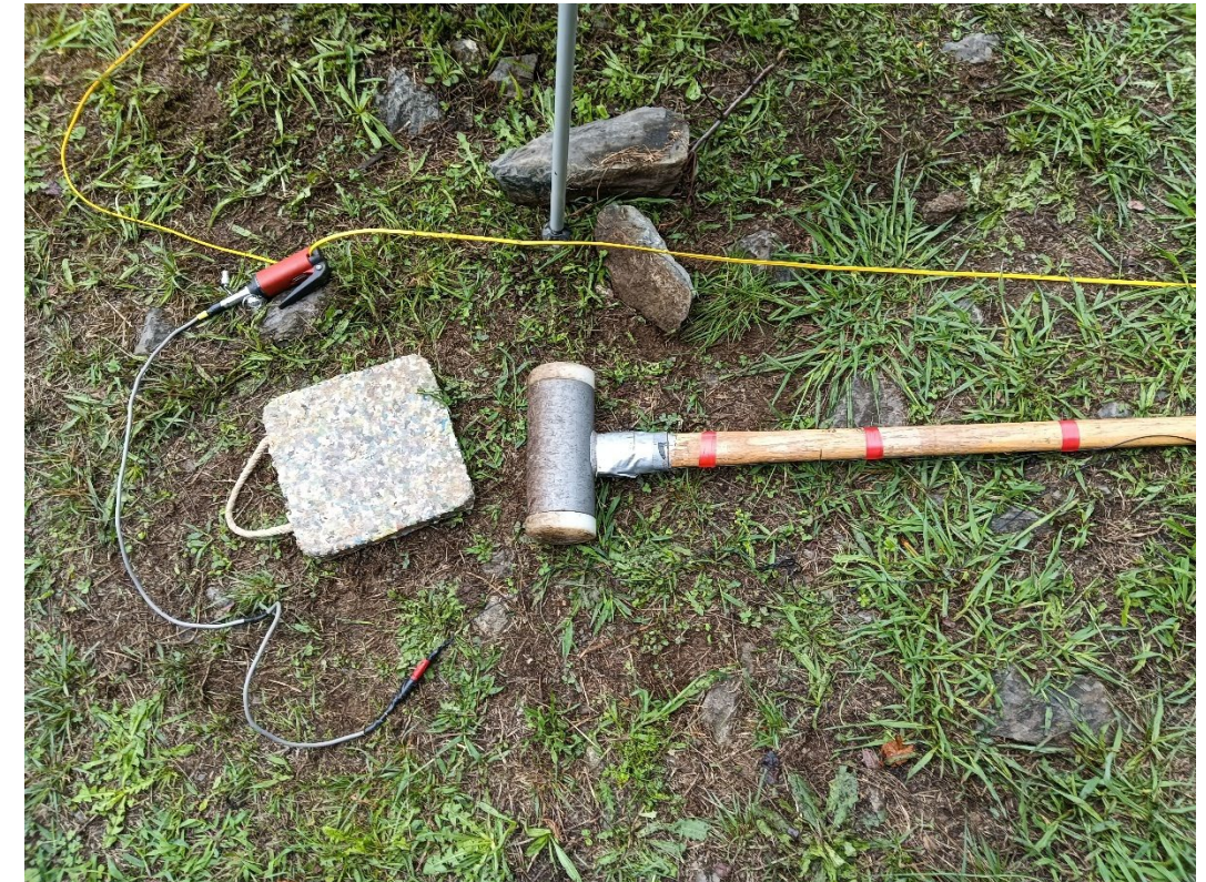
Figura 4. Maza de 9 kg y placa de teflón empleados para la generación de ondas sísmicas y el disparador digital o trigger (color rojo).
