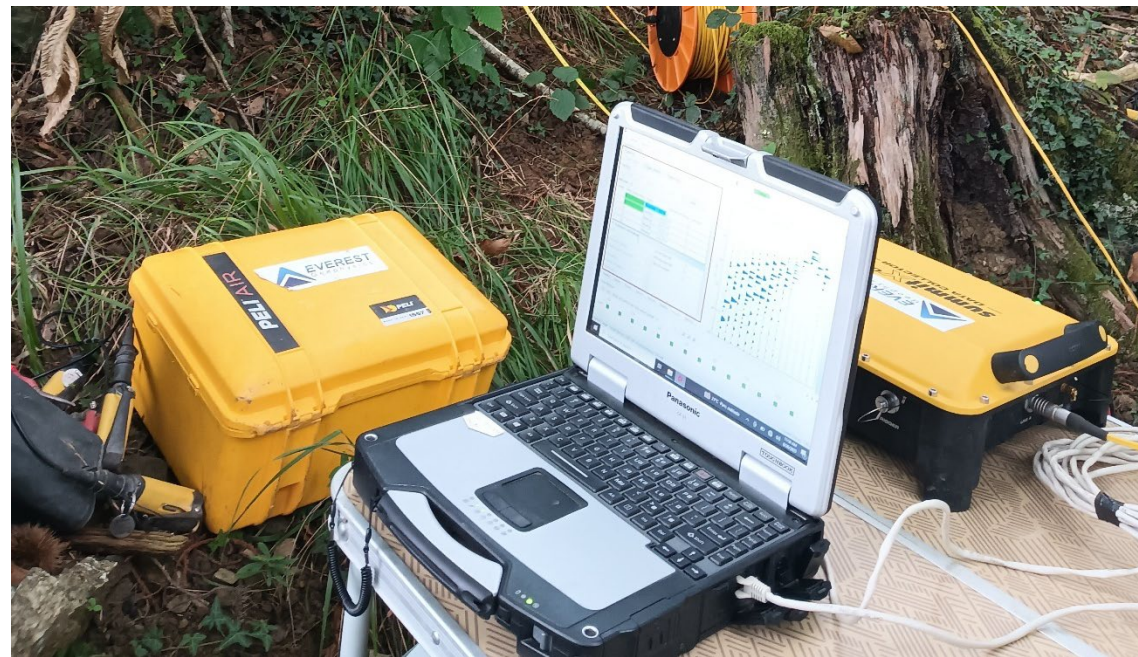
Figura 6. Ordenador de campo empleado en la adquisición de datos sísmicos de campo
