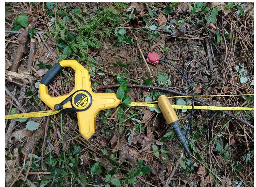
Figura 5. Detalle de uno de los geófonos de componente vertical (rojo) conectado con la unidad de digitalización remota (amarillo) y la cinta métrica.
