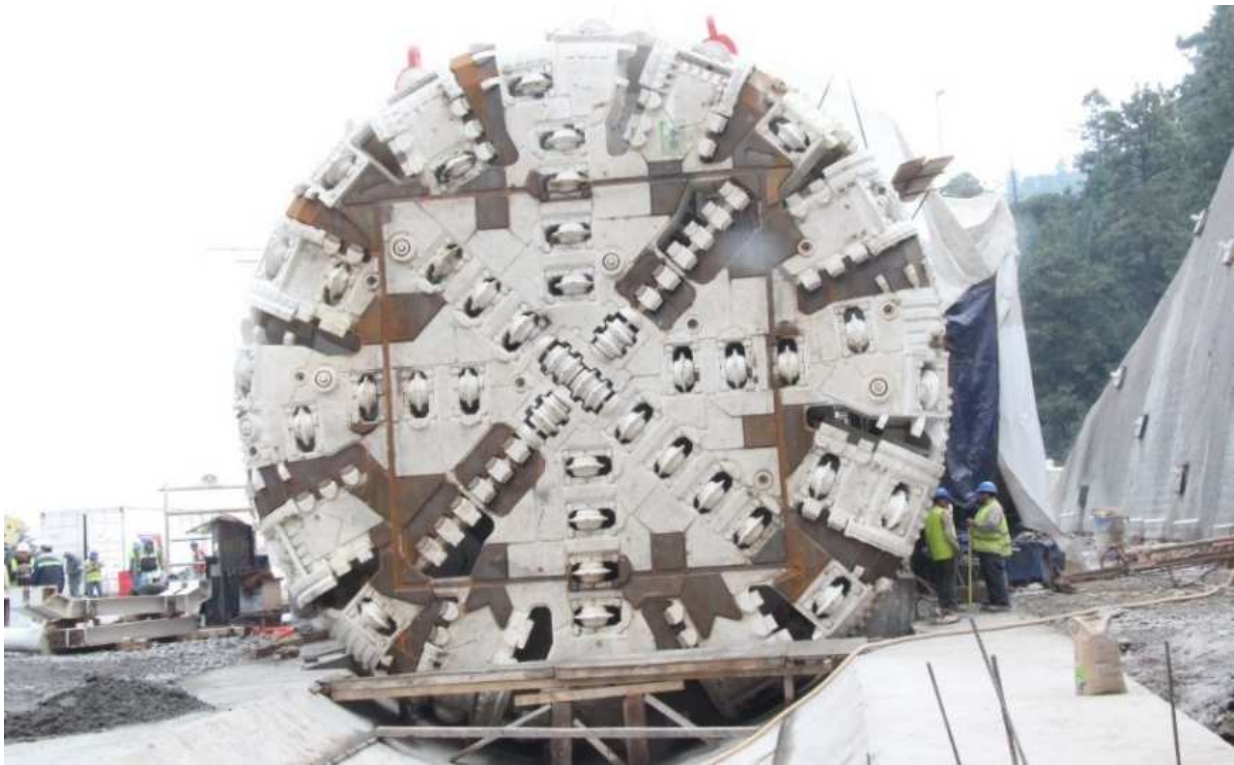
Fotografía 3.2.1.c.- Tuneladora equipada con una cabeza de corte mixta.
