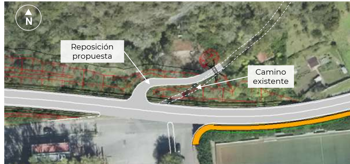
Figura 61. Reposición de camino afectado en PK 0+850
