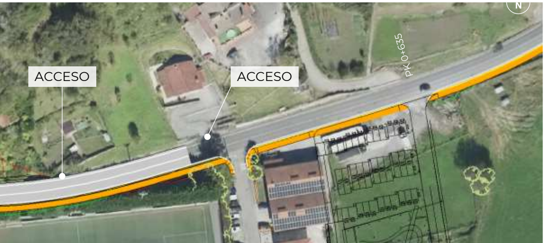
Figura 60. Accesos a propiedades privadas ubicados al inicio del nuevo tramo proyectado
