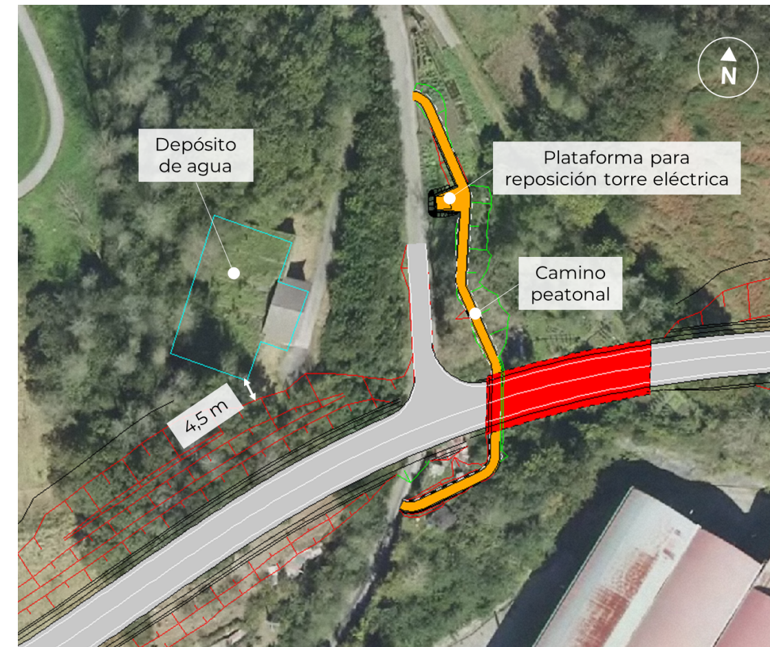
Figura 13. Vista de detalle del cruce de trazado frente al depósito de agua municipal
