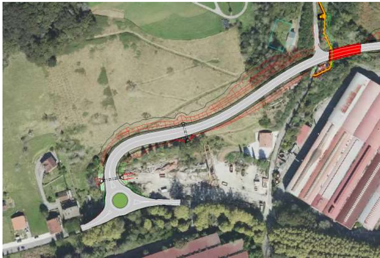
Figura 15. Glorieta proyectada en conexión con carretera NA-4000
