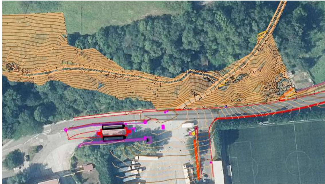
Figura 17. Levantamientos taquimétricos realizados en tramo de acceso a fábrica ArcelorMittal
