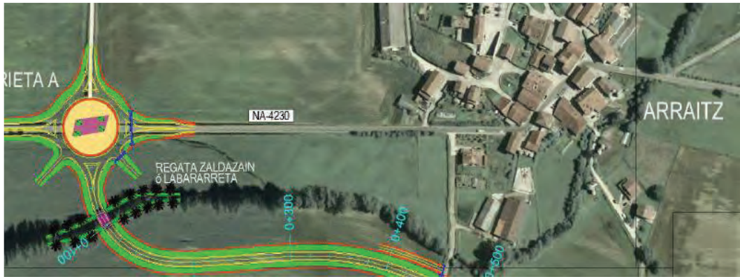
Cruce de la variante por la regata Zaldazain y tramo afectado por el acondicionamiento del cauce.
