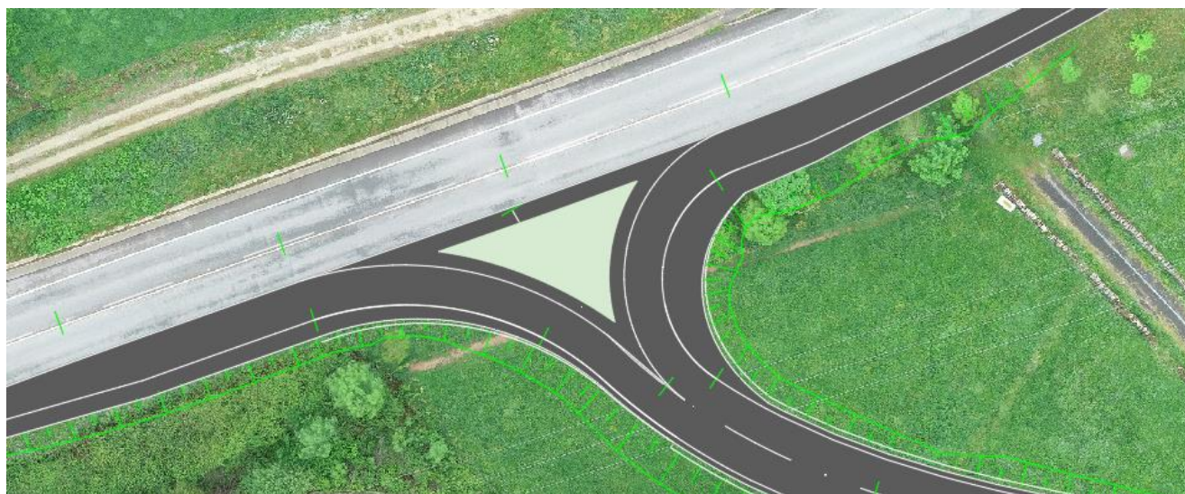
Ilustración 1. Isleta en la conexión de la N-121B y el nuevo acceso a Elizondo.
