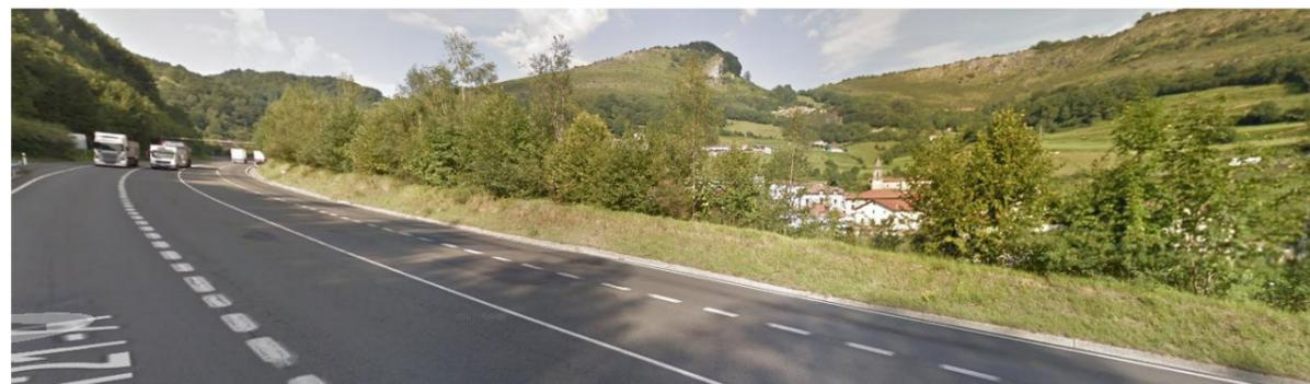
La ampliación de la plataforma de la carretera debe realizarse hacia el exterior, debido que hacia el interior comportaría una elevada afectación al talud de desmonte actual, así como a toda la cuneta existente. La ampliación hacia la exterior comporta la eliminación de la mayor parte de la mota de protección, con lo que para evitar que se pierda la capacidad de protección acústica y visual de la misma, se proyecta la construcción de un muro de gabiones, para mantener la estética actual.
