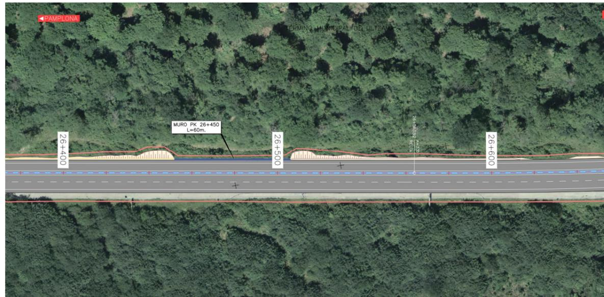
Poco antes de la entrada al túnel de Belate se encuentra el enlace. La nueva plataforma de la N-121A supone la modificación de la parte final de los ramales del enlace actual, que encajan con el nuevo trazado. En el capítulo 4.2 podemos ver el resultado de la comprobación del paso de un autobús característico según la norma 3.1 IC por cada uno de los ramales.
