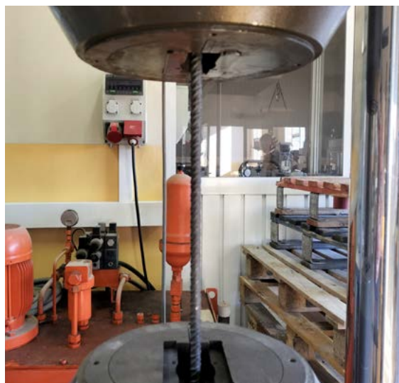
Ensayo a tracción de barras corrugadas.
