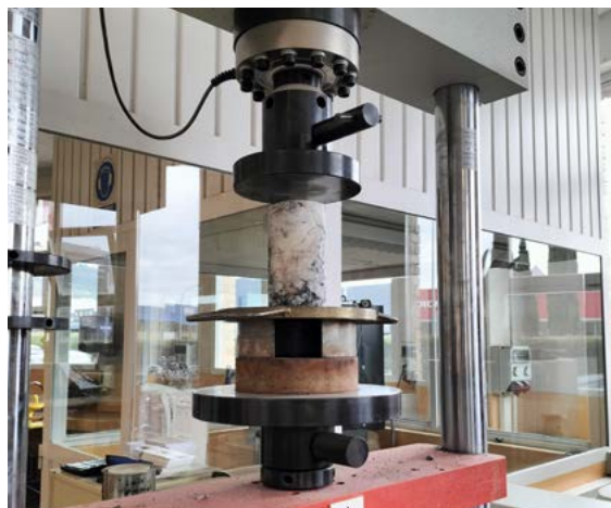
Ensayo a compresión simple de probetas de sondeos.
