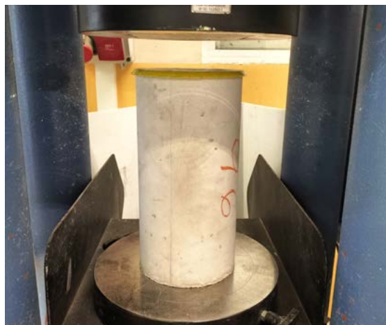
Rotura a compresión de probetas cilíndricas de hormigón.
