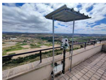
Estación total robotizada, prisma en ladera y prisma fijo.
