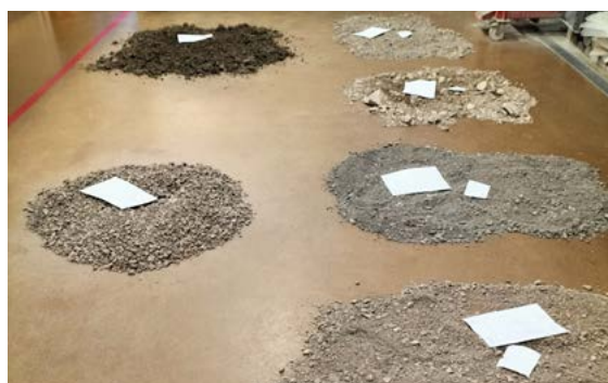
Secado al aire de suelos y zahorras para ensayar su clasificación.
