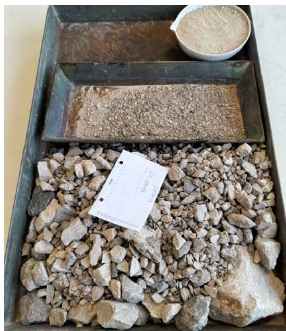
Preparación de áridos para ensayo granulométrico.
