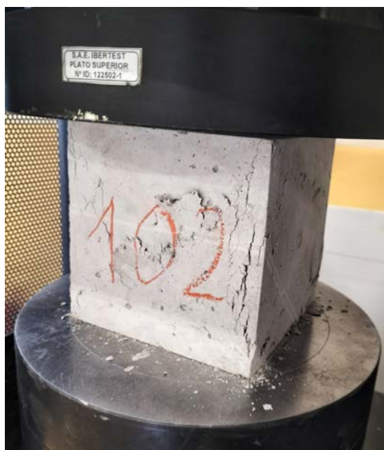
Rotura a compresión de probetas cúbicas de hormigón.
