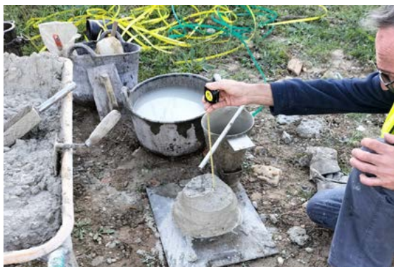
Determinación de la consistencia del hormigón con el cono de Abrams.
