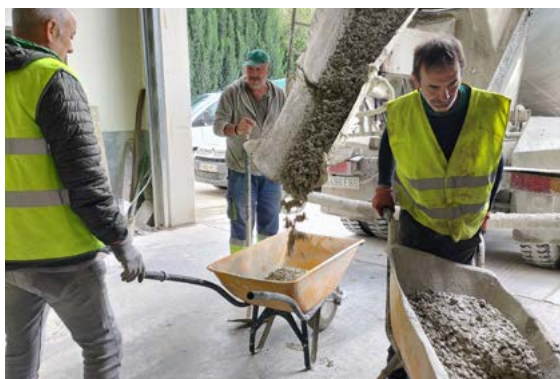
Toma de muestra de hormigón fresco en el ensayo interlaboratorio EILA 24.
