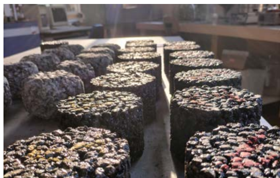
Probetas de mezclas bituminosas antes y después del ensayo Cántabro.
