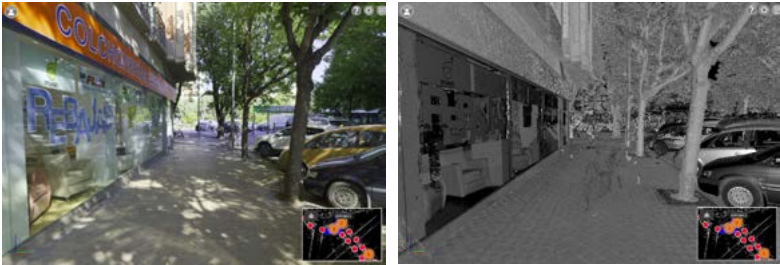
Nube de puntos 3D de una zona del casco urbano de Pamplona en color y en escala de grises.
