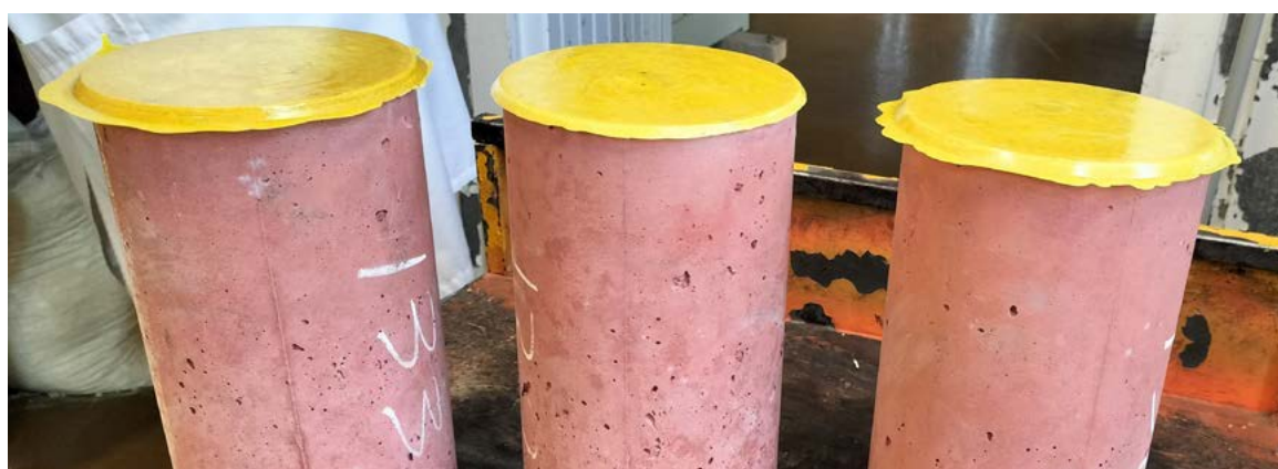
Probetas cilíndricas de hormigón refrentadas con azufre.
