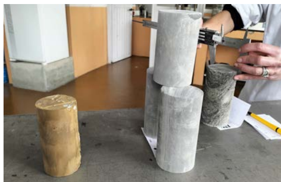
Tallado y medición de muestras de sondeos
