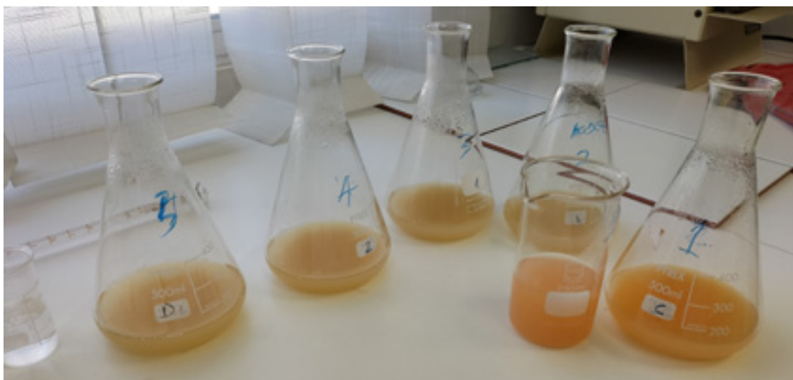
_Determinación de cloruros en testigos de hormigón.
