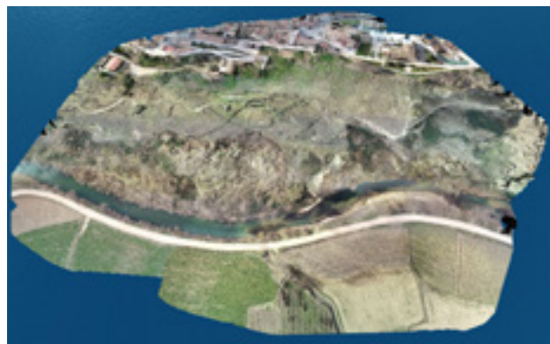
_Esquema de mediciones topográficas realizadas y ortofoto de 3 cm de píxel.
