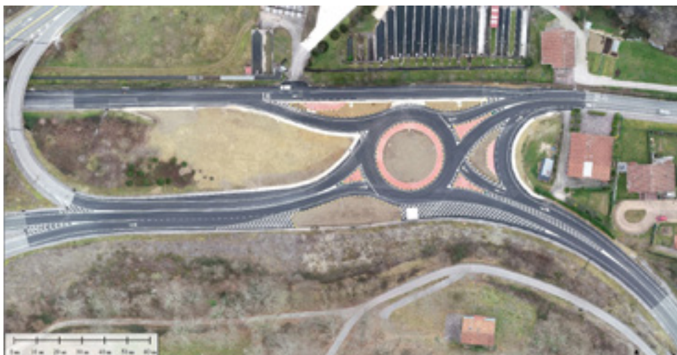
_Ortofotografía de 3 cm de píxel del proyecto con la obra finalizada.
