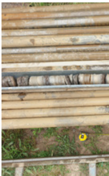
– Detalle de las sales extraídas durante la perforación del sondeo de Guenduláin.
