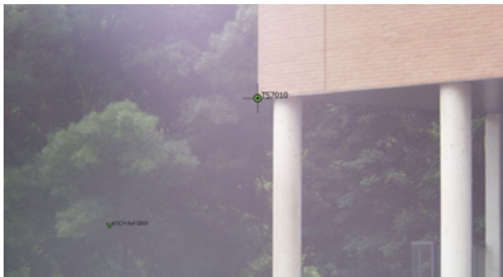
_Levantamiento de una fachada del casco urbano de Pamplona / Iruña, con estación total robotizada Leica MS60.
