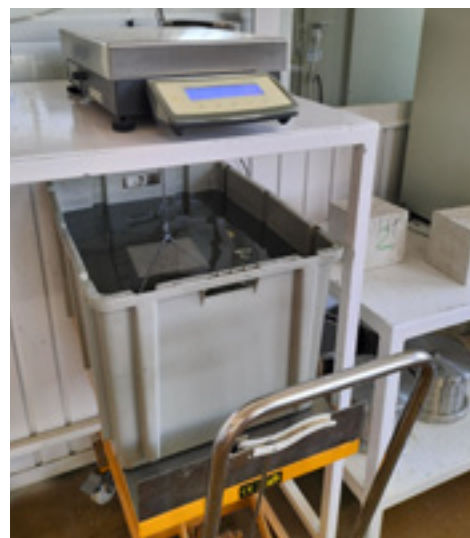
_Medición de la densidad hidrostática de probetas cúbicas de hormigón.
