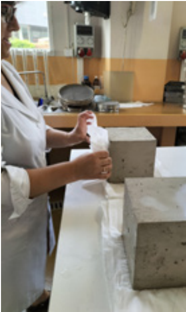
_Secado superficial de probetas de hormigón para determinación de la densidad.
