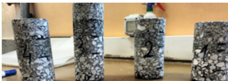
_Testigos con diferentes capas de mezclas de aglomerado.
