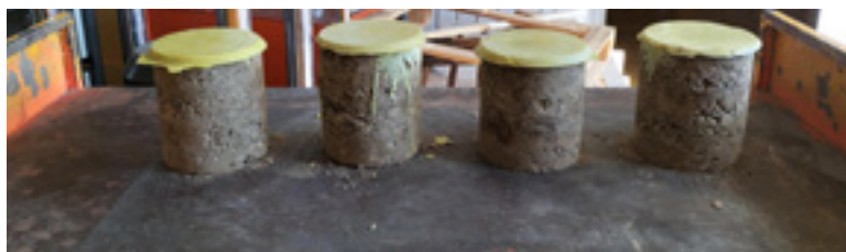
_Probetas de suelo estabilizado refrentadas para el ensayo a compresión.
