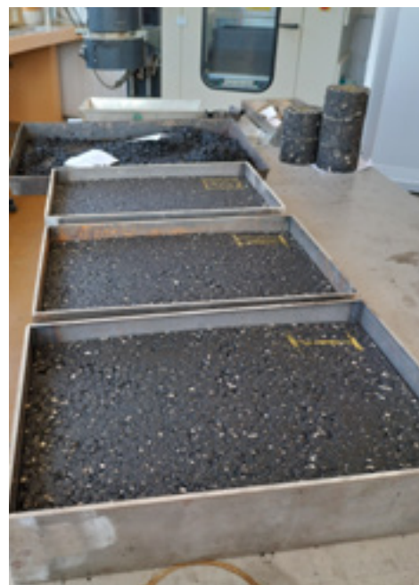
— Preparación de probetas de mezcla bituminosa con compactador de segmento para el ensayo de rodadura.
