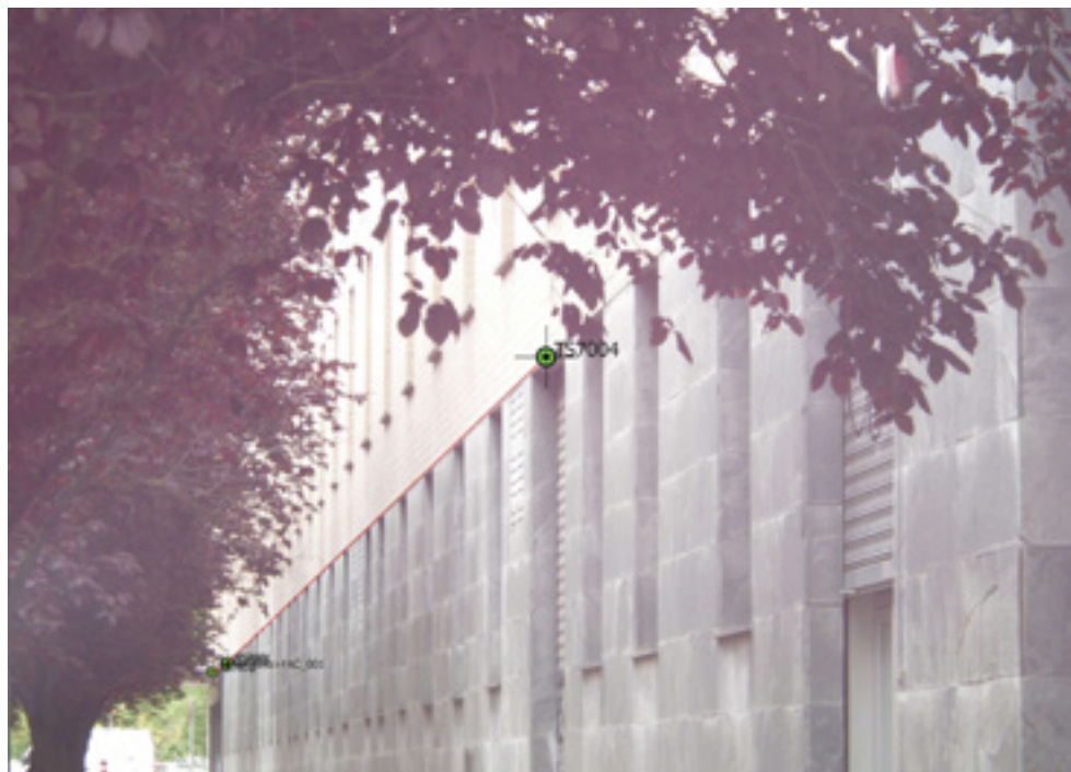
_Levantamiento de una fachada del casco urbano de Pamplona / Iruña, con estación total robotizada Leica MS60.
