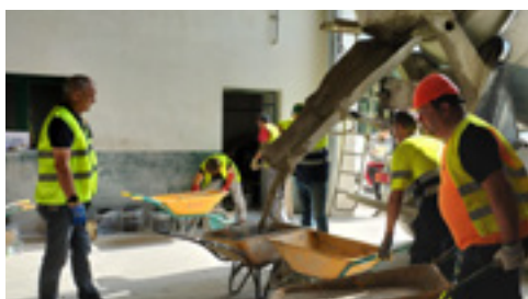
_Toma de hormigón fresco en el estudio interlaboratorio EILA 23.
