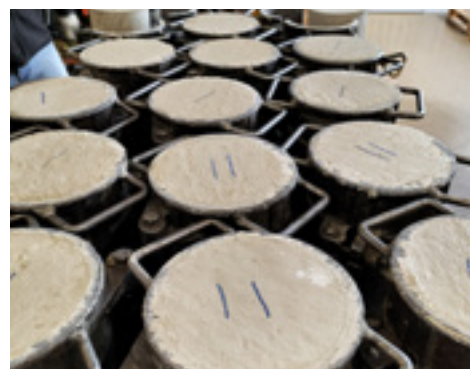
_Probetas de hormigón sin desmoldar.
