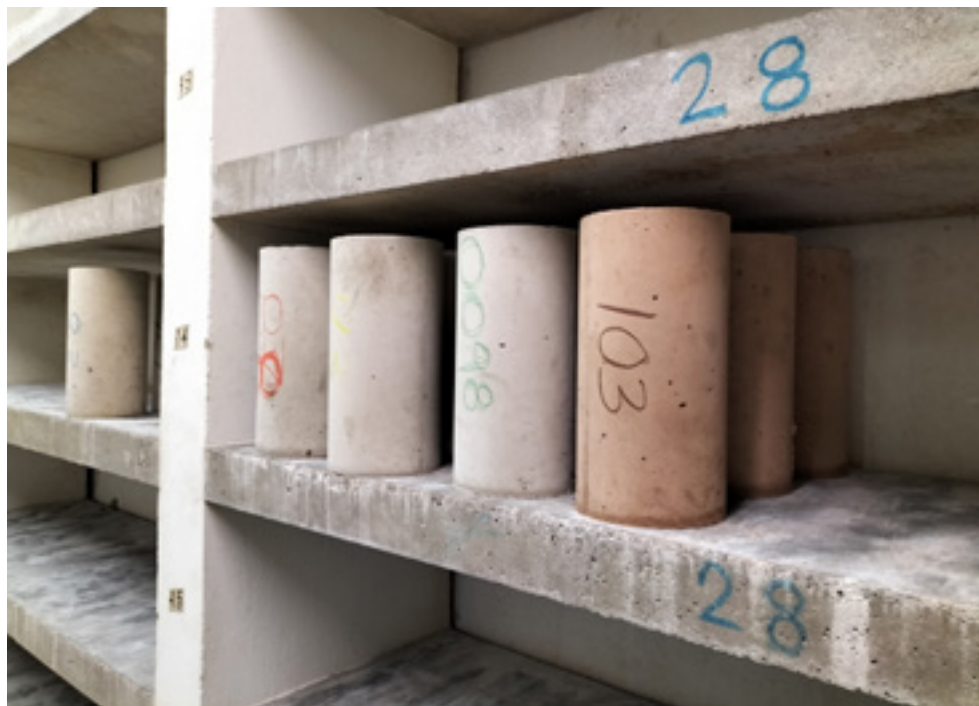
_Cámara húmeda para curado de probetas de hormigón.
