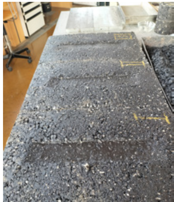
_Huella de la rodadura en las probetas de mezcla bituminosa tras realizar el ensayo.
