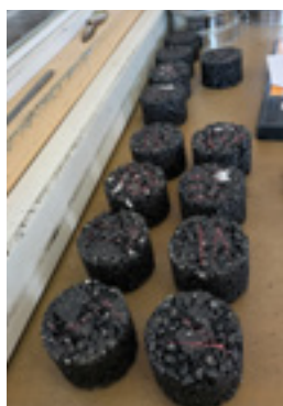
_Probetas compactadas de mezcla bituminosa para el ensayo de sensibilidad al agua.
