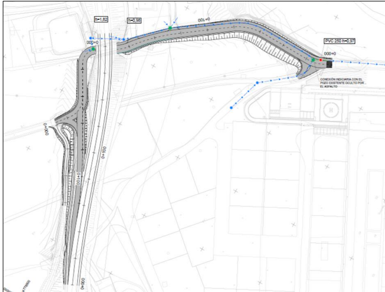
Red de saneamiento y reposición de afecciones
