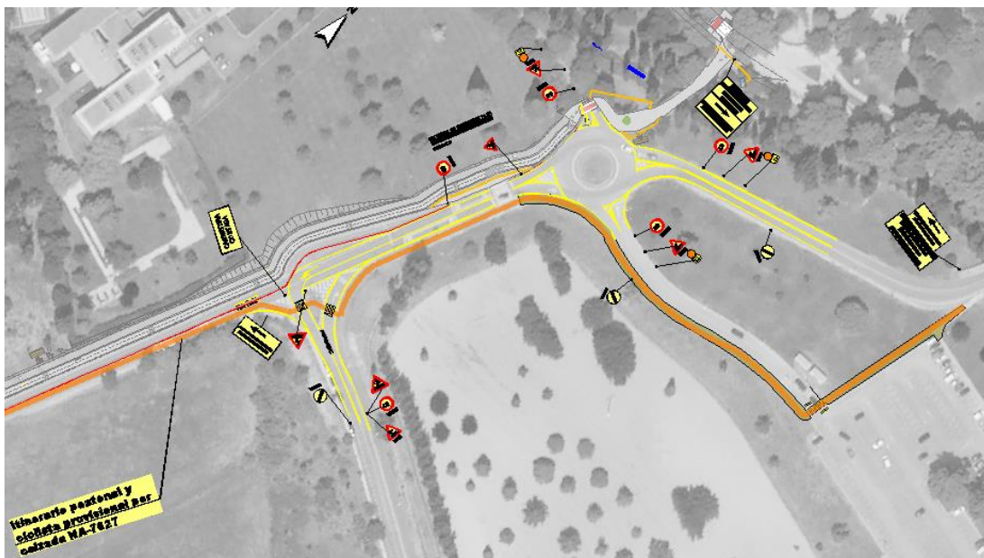
Figura nº 2: Itinerario peatonal (en naranja) durante ejecución de tramo 1.
