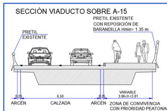
Figura nº1: sección Viaducto sobre A-15
