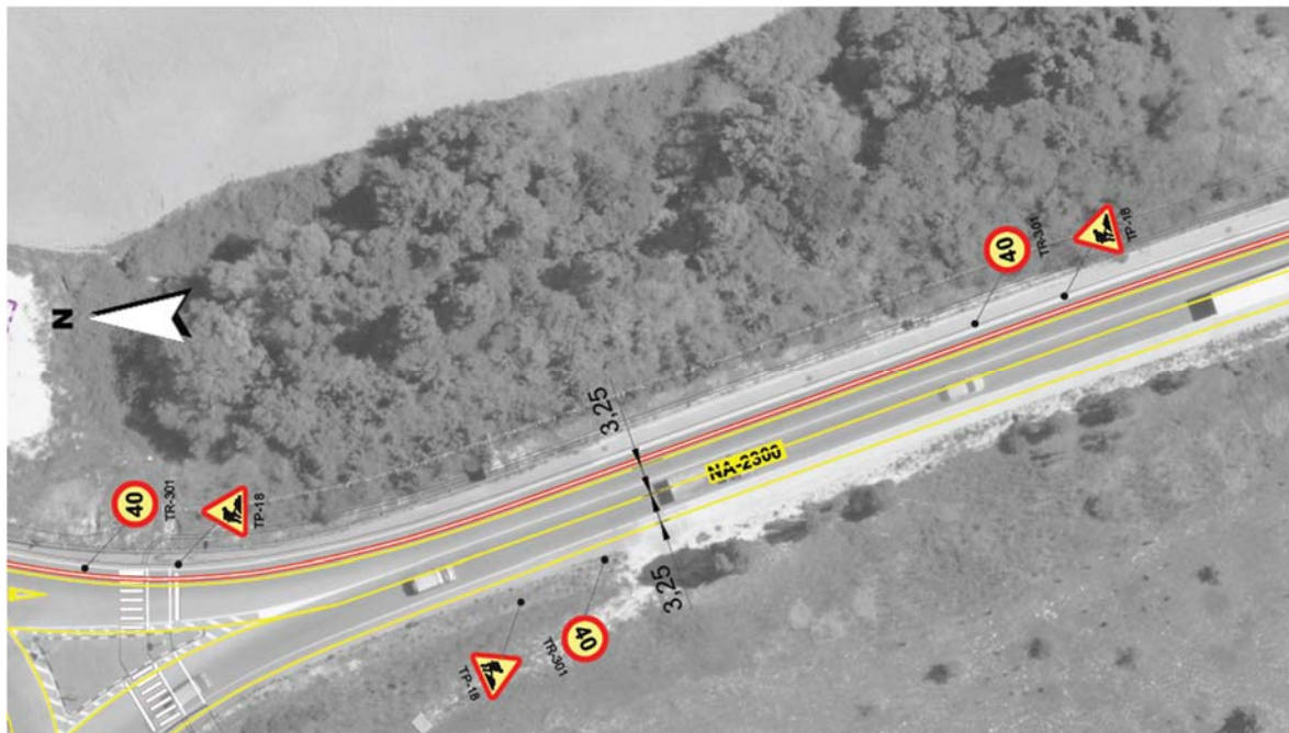
Figura nº 2: detalle de la señalización de obra en el tramo 3.
