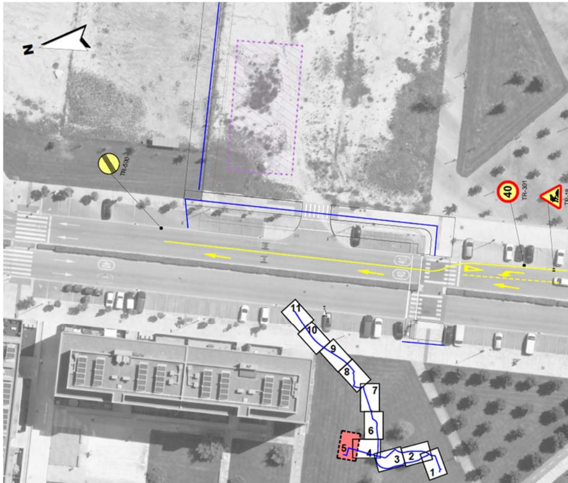
Figura nº 6: detalle del corte de carril de circulación en la calle Roma de Ripagaina
