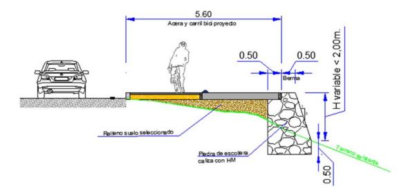
Figura nº 1: sección tipo Eje 3 con escollera
