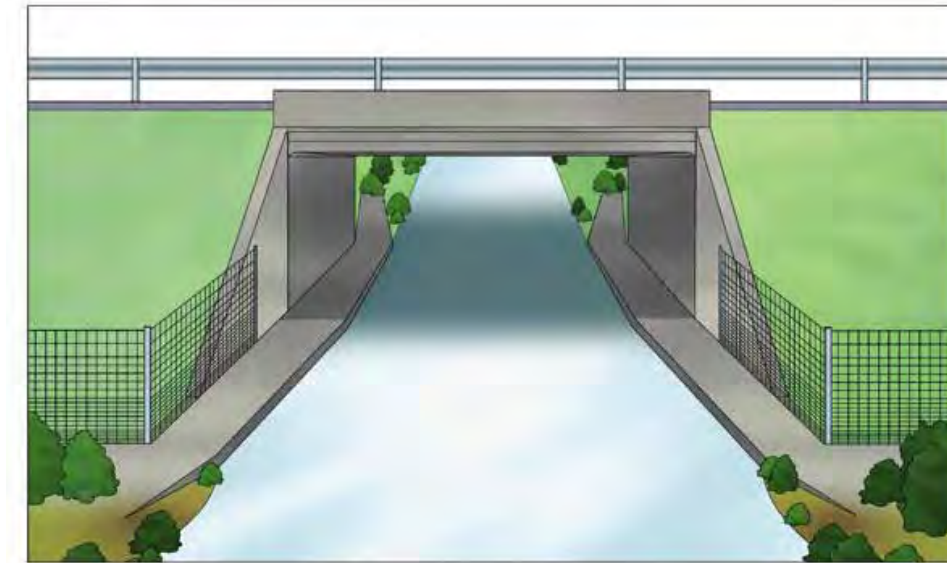
Ilustración 13. Drenaje adaptado al paso de fauna. Fuente: Prescripciones técnicas para el diseño de pasos de fauna y vallados perimetrales. Ministerio de Agricultura, Alimentación y Medio Ambiente.
