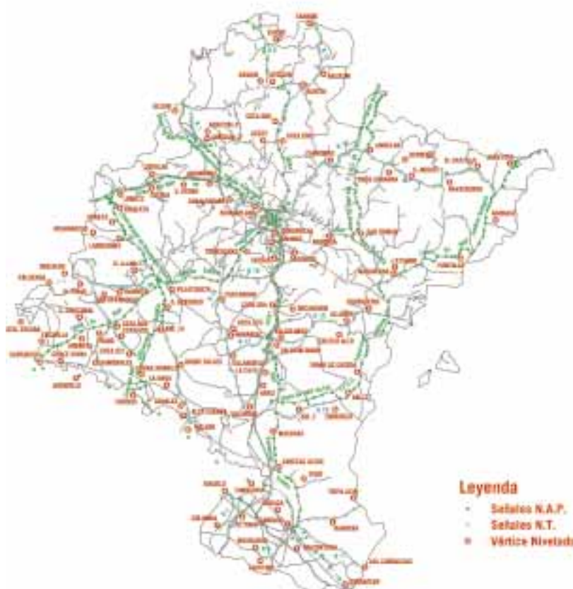
Red conjunta de nivelación geodésica y topográfica.
