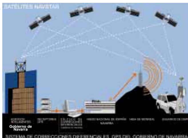
Estación de referencia GPS.
